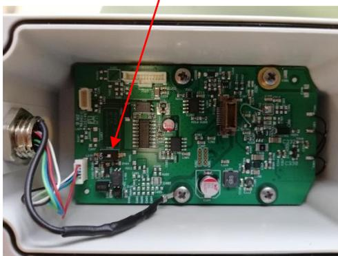
Alternativ dazu kann auch ein 120R Widerstand im Stecker zwischen Pin 2 und Pin 4 verbaut werden. Beim Zusammenbau auf korrekten Sitz der Gehäusedichtung achten.
