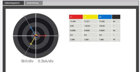
Vektordiagramm zur Anschlusskontrolle
