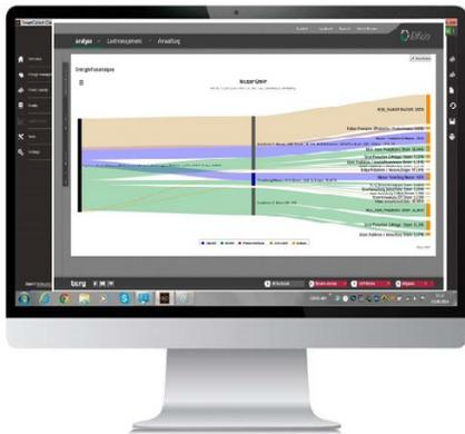
Efficio ist eine Energiemanagementsoftware welche auf einfache Art und Weise Messdaten erfassen kann und diese in einer Postgre SQL-Datenbank ablegt. Die Software bietet Grundfunktionalitäten zur Datenanalyse und für ein einfaches Energie-Monitoring sowie zum einfachen Erstellen und Versenden von Reports.
